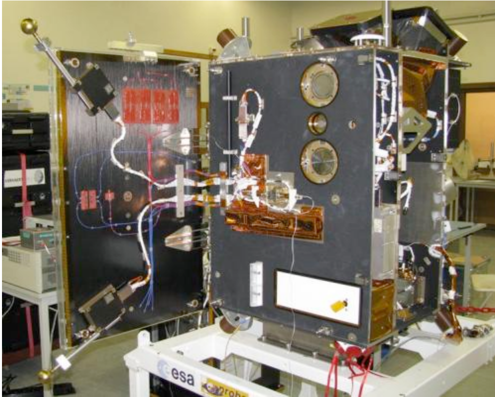
Figuur 32: Zijaanzicht van de PROBA2 satelliet. Aan de linkerkant zijn de twee sondes van het DSLP-instrument te zien. De twee cirkels op het middenpaneel zijn onderdeel van TPMU.
