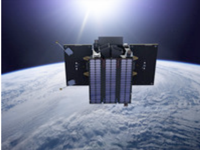
Figuur 25: PROBA2 kijkt naar de Zon. Aan de achterkant van de satelliet zijn de DSLP-antennes, de star trackers en cilindrische de S-band antennes die worden gebruikt voor de communicatie met de grond te zien. SWAP en LYRA bevinden zich aan de linkerzijkant van de satelliet.
