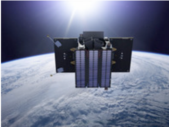
Figuur 25: PROBA2 kijkt naar de Zon. Aan de achterkant van de satelliet zijn de DSLP-antennes, de star trackers en cilindrische de S-band antennes die worden gebruikt voor de communicatie met de grond te zien. SWAP en LYRA bevinden zich aan de linkerzijde van de satelliet.
